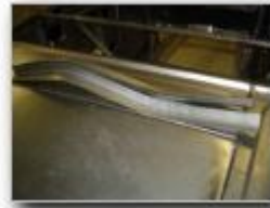
Plåtarna som förbindr subrail med bakre hjulhus invändigt.
